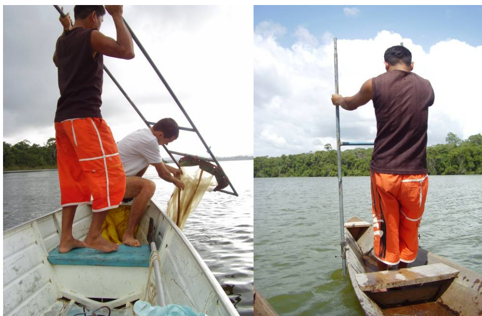
FIGURA 13.3.4-8 – Forma de uso da rede de ictioplâncton para garantir amostras a diferentes profundidades.
